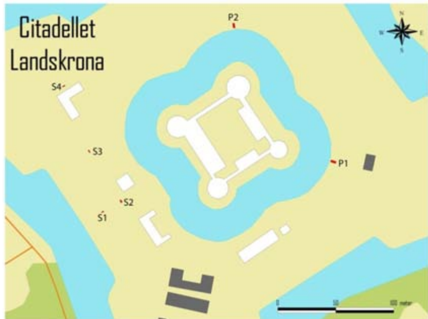
Fig 10. Provschakten invid den inre vallgraven (P1-2) syftade till att se hur vallgravskanten var uppbyggd och beskaffenheten på de intilliggande jordmassorna. Syftet med schakt 1-4 var att fastställa hur mycket jordmassor som påförts under 1900-talet och vilka insatser som krävdes för att omforma marken så att en fungerande dränering runt byggnaderna kunde erhållas.
