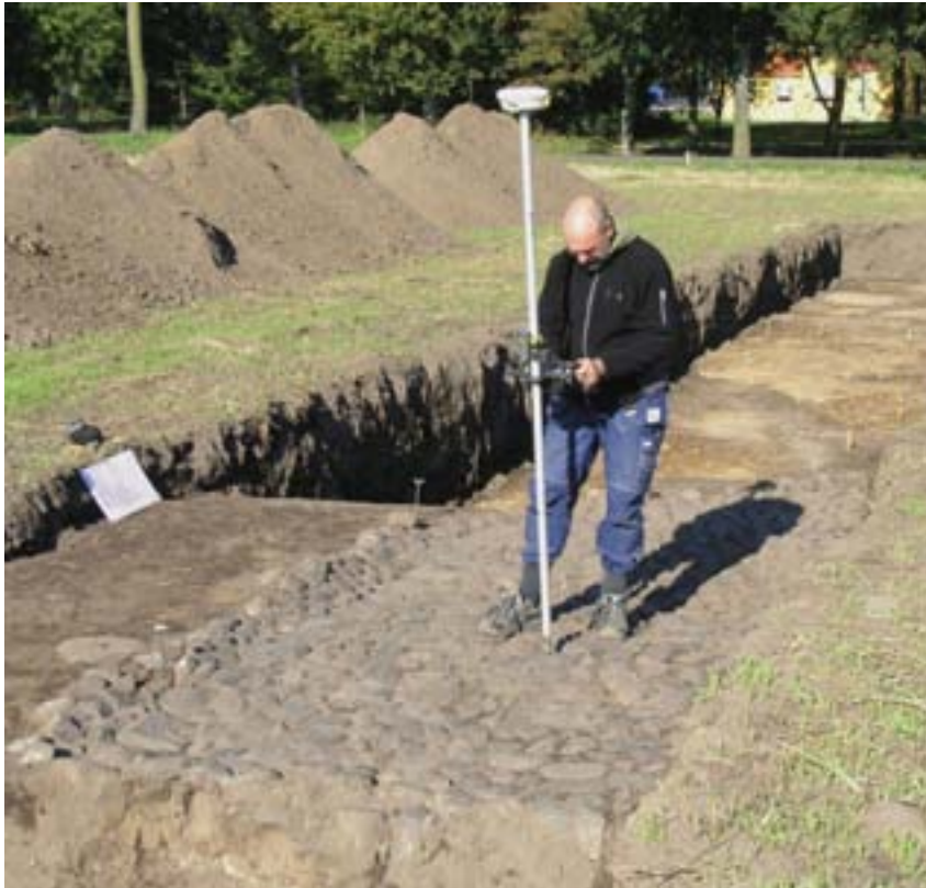
Fig 19. Claes Telliander mäter omsorgsfullt in stenläggningen. Ofta kombinerades den digitala inmätningen med handgjorda ritningar.
