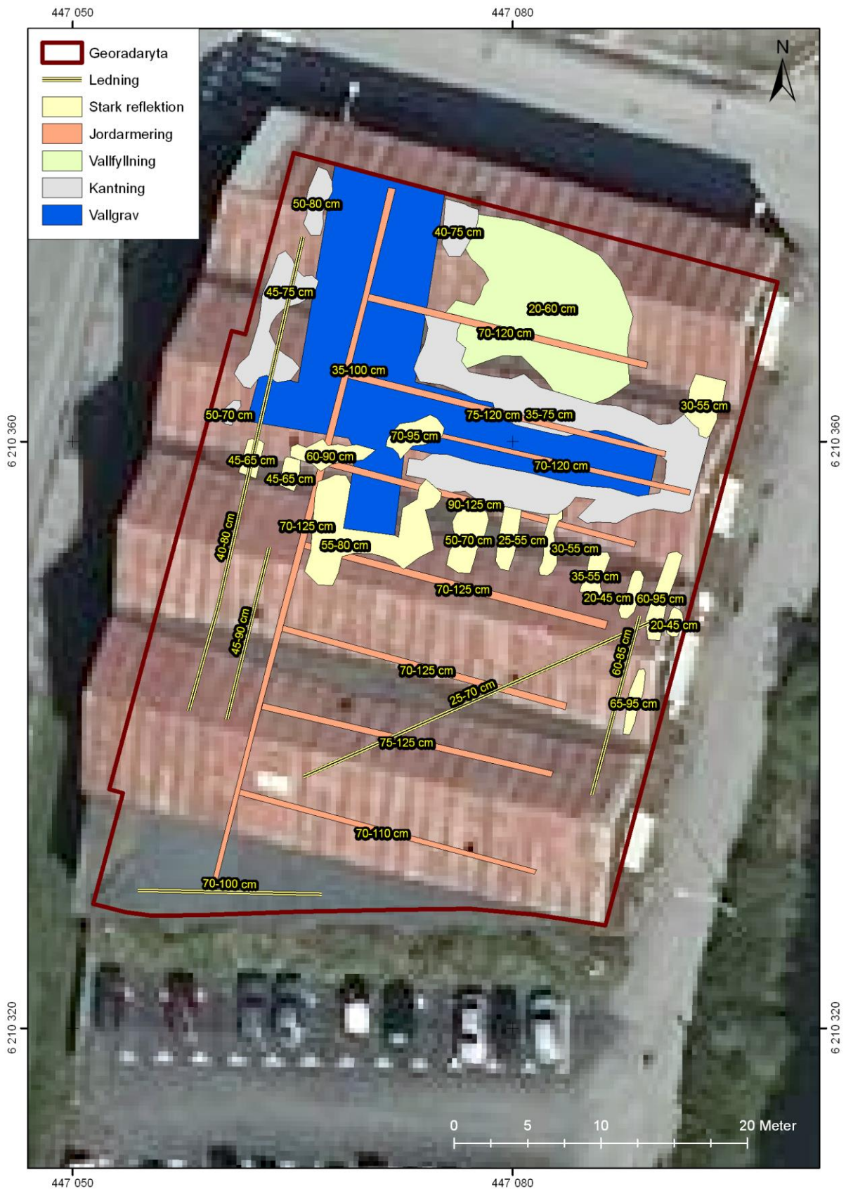
Figur 12. Strukturer registrerade vid karteringen med georadar med relativa djupangivelser inlagda. Notera att detta inte utgör några exakta nivåer, men att det inbördes förhållandet mellan respektive anomalier alltid är korrekt.
