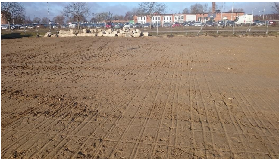
Figur 5. Det avjämnade bärlagret under pågående kartering med georadar (GPR) 2021.03.01. Spåren efter den källa som GPR-antennen är upphängd i täcker ytan. Foto: Claes Pettersson, Sydsvensk Arkeologi.
