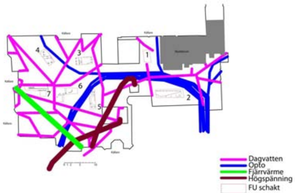
Fig. 3. Schaktöversikt samt ledningsöversikt.
