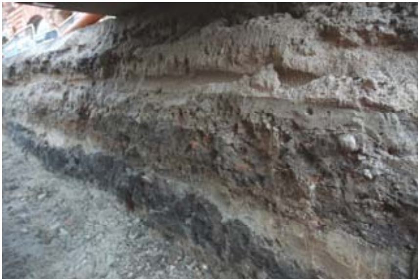
Figur 11. Schakt 3, sektion åt öster vid +29 m. Lagerbilden domineras av en utfyllnad i form av raseringsmassor med tegelfragment, träkol och kalkbruk. I botten på schaktet finns ett svart humöst fett kulturlager.
